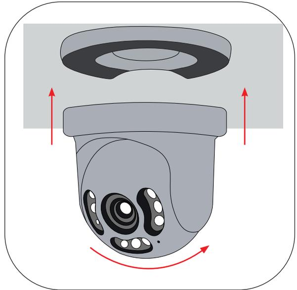
*Kamera in die Halterung setzen.*
