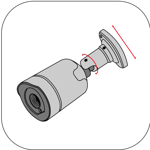
Schraube nach der Positionierung festdrehen.
