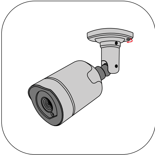
Schraube mit beiliegendem Werkzeug lösen.
