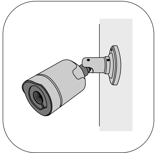
Schraube nach der Positionierung festdrehen.
