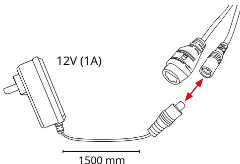
**1** Netzteil anschließen
