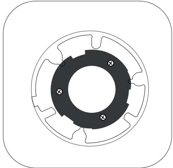
*Unterseite Kamera: Halterung von der Kamera nehmen.*
