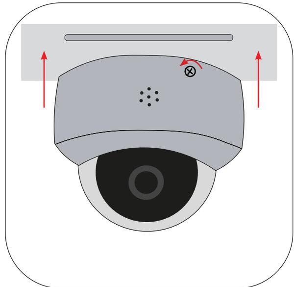
*Kamera in die Halterung setzen, reindreihen und die Schraube wieder festziehen.*
