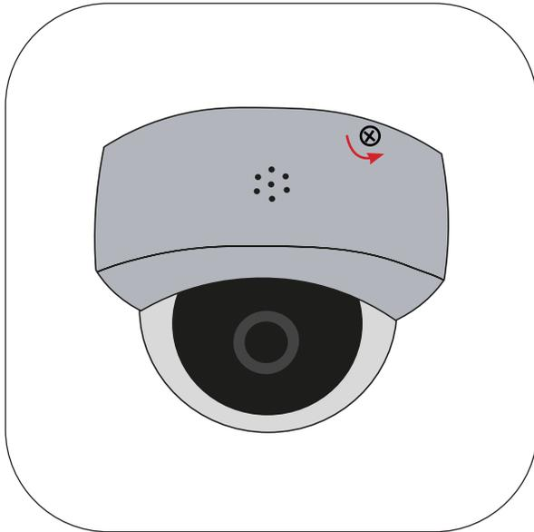
*Gehäuse der Kamera muss zur Montage nicht geöffnet werden. Schraube lösen.*
