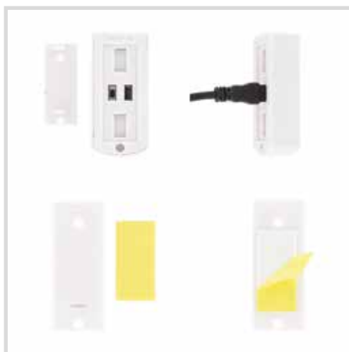
Abb. C Sensor und Kontakt mit Klebestreifen montieren. Zum Laden den Sensor ausschalten und ein USB-Kabel anschließen. Ladezeit ca. 4 Stunden.
