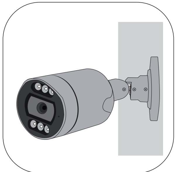
Schrauben nach der Positionierung festdrehen.
