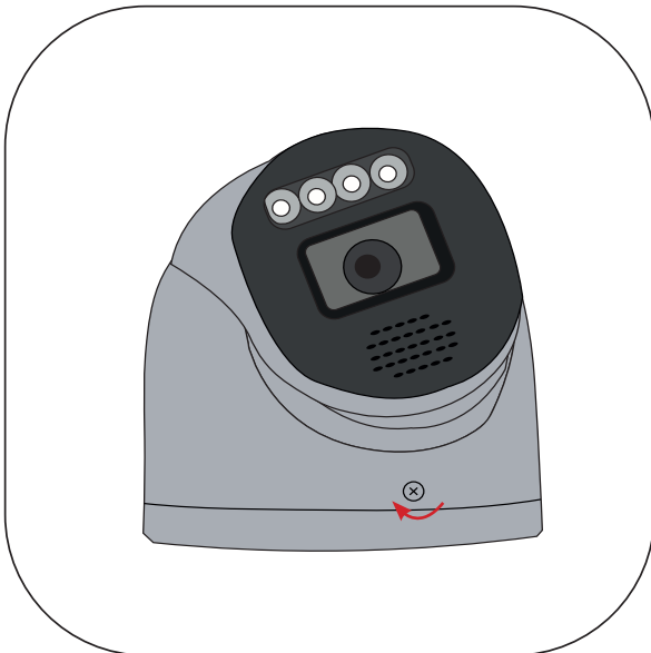
Schrauben nach der Positionierung festdrehen.
