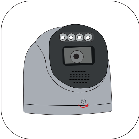
Schraube mit beiliegendem Werkzeug lösen.
