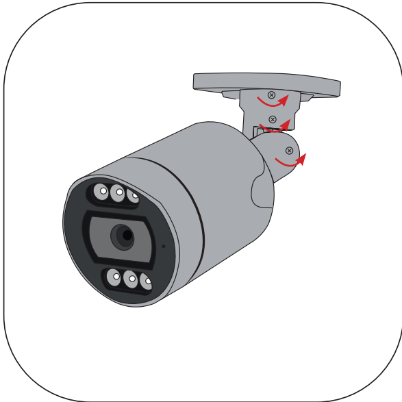
Schraube mit beiliegendem Werkzeug lösen.
