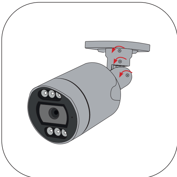
Schrauben nach der Positionierung festdrehen.
