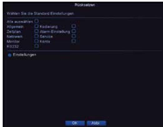
**HINWEIS:** Anschließend sollten Sie den HDDVR neu starten. Achten Sie darauf, dass nach dem Neustart die Einstellung "DHCP" im HDDVR-Menü "Netzwerk" aktiviert ist, bevor Sie die Kameras wieder einbinden.
