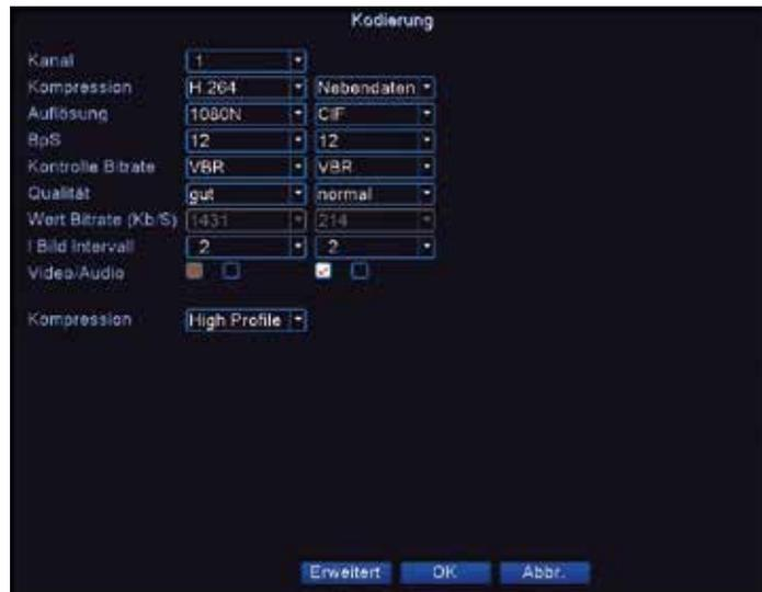
Wechseln Sie in das Menü: **Hauptmenü > System > Kodierung**, um die Einstellungen der einzelnen Kameras zu ändern.
