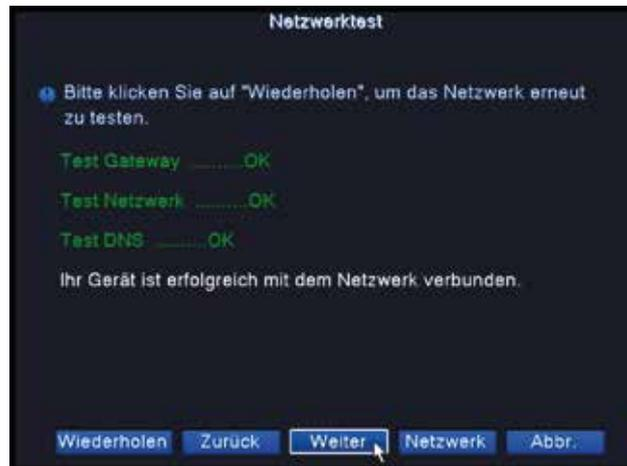
Nun testet der HDDVR das Netzwerk und zeigt, nach ordnungsgemäßem Anschluss, folgende Meldung: "Ihr Gerät ist erfolgreich mit dem Netzwerk verbunden."
